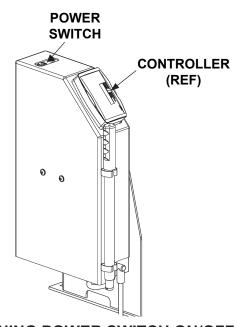
TURNING POWER SWITCH ON/OFF (LH PUMP SHOWN) FIG. 48-2
